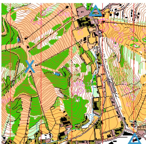
なお、GPS での骨格調査方法であるが、左図に示すとおり、太郎山山頂 (X 印) を第一基準点として、原図の位置合わせを行い、第二次基準点として、今回の会場であった鈴蘭館およびホテル白樺荘 (△印) を設定し、各々数時間の GPS データを取得した。これらの経緯度データから、第一次基準点を絶対位置として固定し、第二次基準点は、歪みのないことのチェックのために使用するとともに、原図の骨格としている。そこで、これら 3 点を基準に OCAD の GPS 機能を使い、Adjust (整合・調整) 設定 (下図) を行い、骨格調査は行っている。その結果が前述のプロット図である。GPS データが役に立ったのは、このスキー場部分だけでなく、6・7 走にて使用した範囲である今回新たに付け加えた太郎山北部の森林においても、この GPS データが大いに役に立った。この部分は、全く原図がなく、周囲も C 蔵に囲まれているため、どこに位置するのかさえ分からぬ状況であったが、GPS を用いることにより、およそ 1 日で範囲内の骨格を完成することが出来た。
